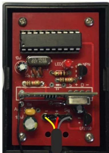
Die neue Platine ist ausgelegt für 433 Module mit 5 Volt oder auch 3 Volt Spannung.
