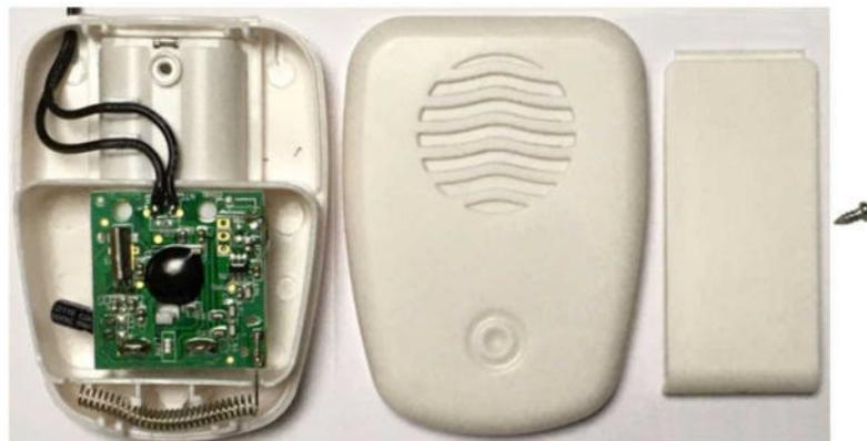
Das Gehäuse schließen, oben dort wo die Antenne ist einhaken und zusammen drücken.
